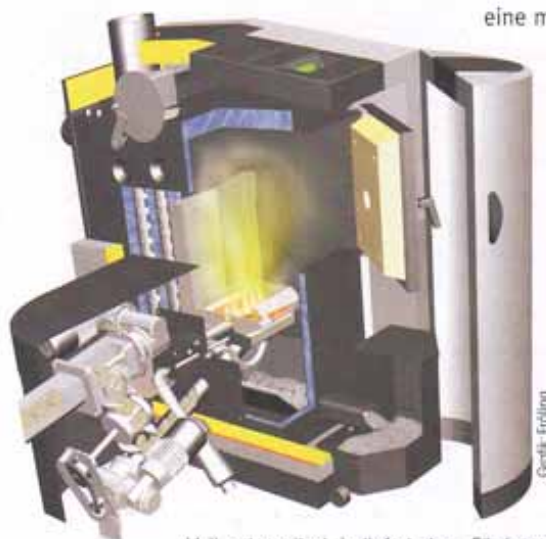
Voll automatisch beliefert eine „Förderschnecke“ den Heizkessel mit Pellets. Die Leistung der Anlage wird über die Menge der zugeführten Brennstoffe reguliert.
